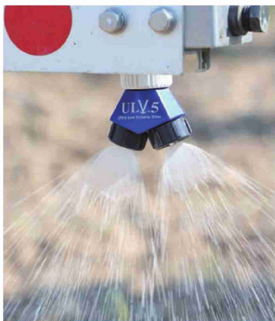
ラウンドアップマックスロード専用ノズル「ラウンドノズルULV5-Light Boom用」
